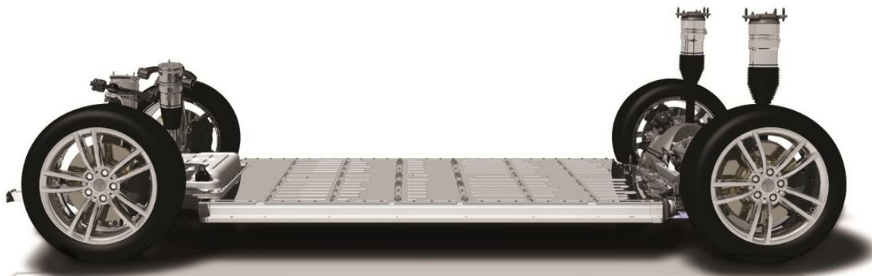
SLIKA 1 – PRIKAZ POZICIJE BATERIJSKOG SISTEMA U ELEKTRIČNIM AUTOMOBILIMA (IZVOR: WWW.AUTOREPLIKA.COM)
